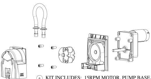
6 KIT INCLUDES: 15RPM MOTOR, PUMP BASE, PUMP COVER, 3 ROLLER FIXED ROLLER BLOCK AND EPDM SQ. TUBE
